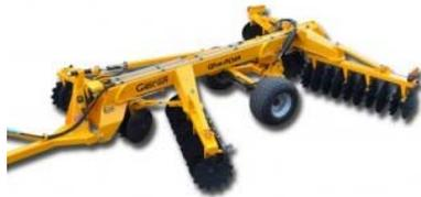
Se trata de la nueva grada de disco plegable **GRM**, enmarcada en la gama **Eos** de Gascón, la cual está dotada de un bastidor central monoviga de 300×300 mm. de sección, sobre el cual se unen todos sus elementos.
